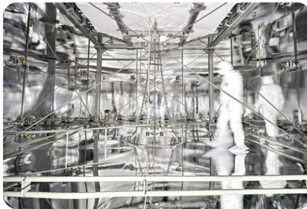
一位工人小心翼翼地在外围探测室的地板上踱步，他穿着特殊的实验服，可以避免污染设备。主探测器位于上方白布后面。操作时，整个空间都充满了水。
